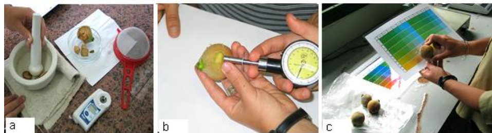
FIGURA 7: Determinación sólidos solubles (a), firmeza (b) y color (c) en frutos de membrilleros
