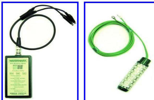
Figura 9: Lector digital de resistencia eléctrica (izquierda) y sensor de resistencia eléctrica (derecha) . UNRC. Río Cuarto Córdoba.
