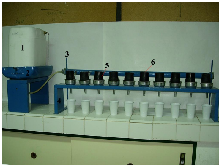
Figura 2.1. Estructura para realizar las determinaciones de Ks
