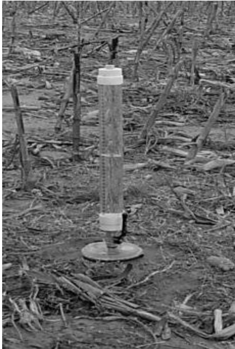
Fotografía 1: Permeámetro de disco utilizado en el presente trabajo.
