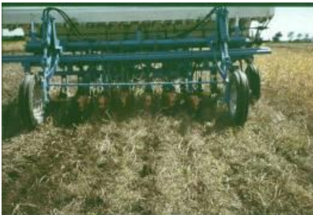
Figura 2: Prototipo sembrando sobre suelo con labranza anticipada.
