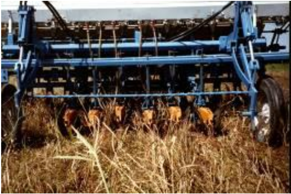
Figura 3: Prototipo sembrando sobre rastrojo sin labranza anticipada.
