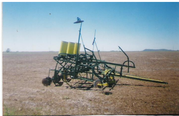
Figura N° 3: Fotografía de la sembradora de grano grueso Mazorca modificada para realizar el ensayo con tres surcos y un espaciamiento de 70 cm.
