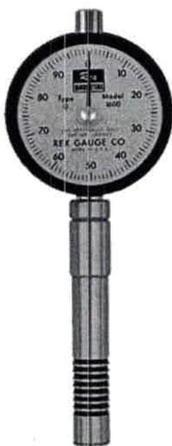
**Figura 2-6:** Durómetro utilizado, marca Rex modelo 1600 tipo D.
