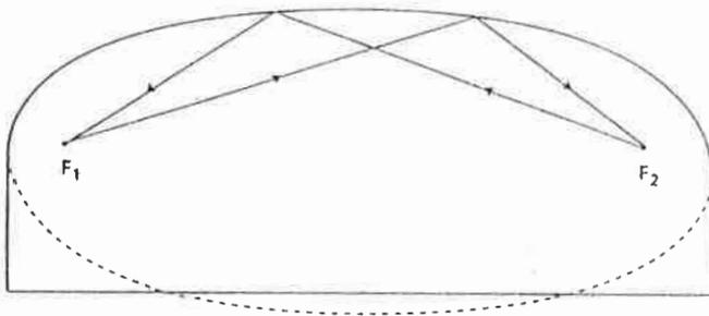
**c** | ¿Cómo se puede realizar el dibujo de una planta o de una bóveda elíptica?
