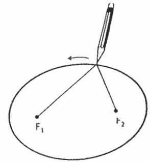
Podemos observar que la suma de las distancias de cualquier punto de la curva a  $F_1$  y  $F_2$  es constante, e igual a la longitud del hilo utilizado. Esta construcción está basada en la definición de elipse como lugar geométrico:
