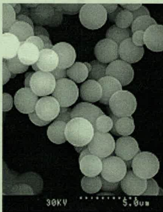
Figura: 1.9 Fotografía SEM de micro partículas porosas de aerogel 29 .
