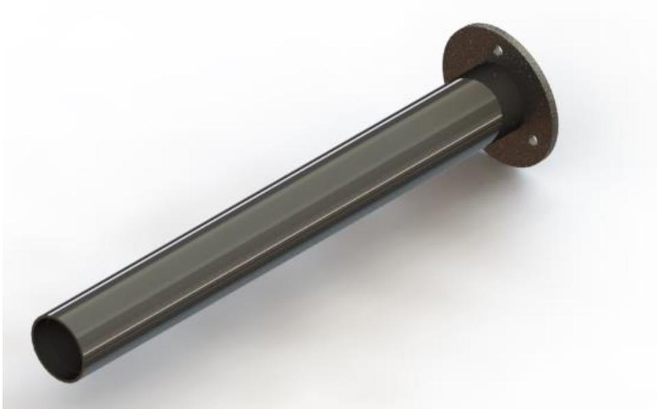
*Vista Isométrica Soporte Estator*
