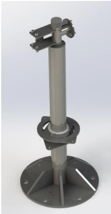
Además, contiene las piezas del sistema de freno 360, necesario para poder frenar el equipo en cualquier momento sin importar la dirección en la que se encuentre la turbina.
