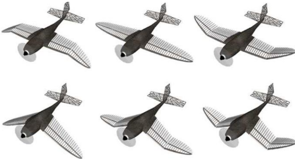
Figura 1-7: Configuraciones de un UAV con alas flexibles inspirado en las gaviotas (Abdulrahim y Lind, 2005).
