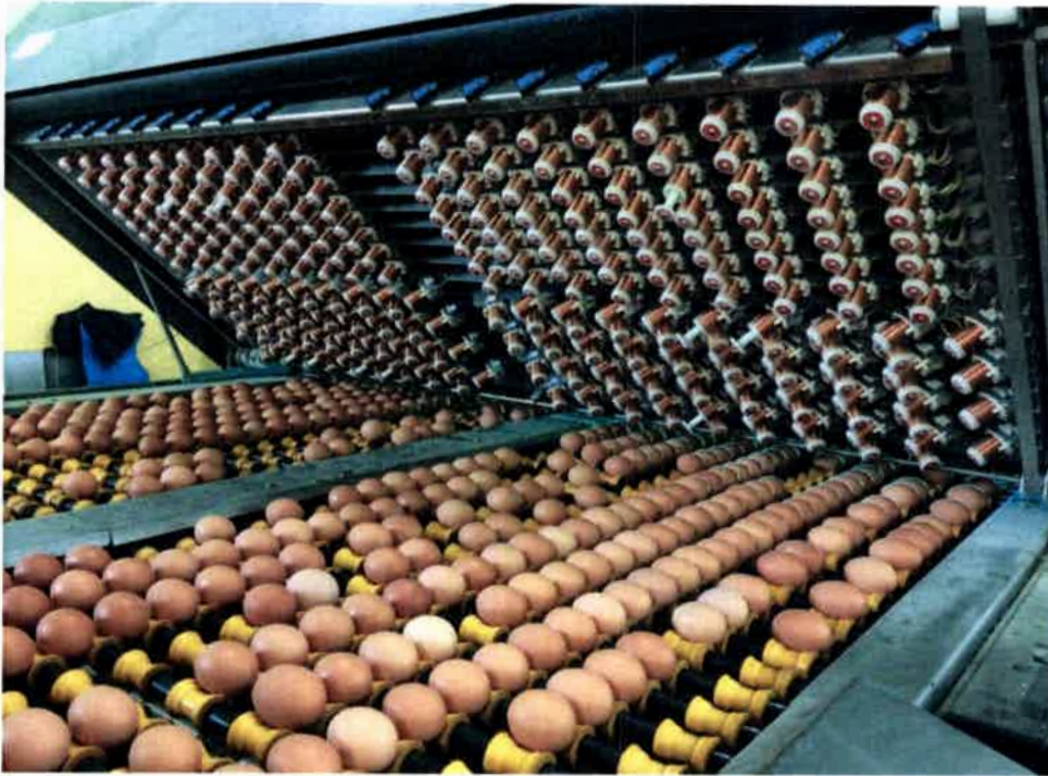
Imagen N° 14: Sector de detección de fisuras en la seleccionadora de huevos.
