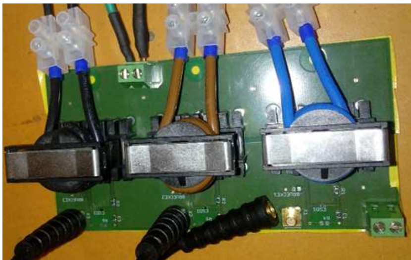
Figura A.5: Imagen de los sensores de derivada de corriente (SDC).
