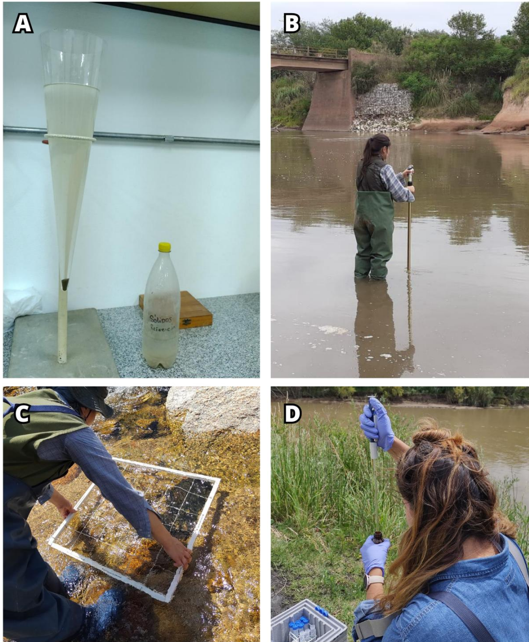
Figura 27. Metodología de laboratorio empleada para la (A) medición de sólidos sedimentables, y metodología de campo para la evaluación de: (B) variables hidráulicas, (C) composición porcentual granulométrica del sustrato y (D) determinación de metales pesados en agua.
