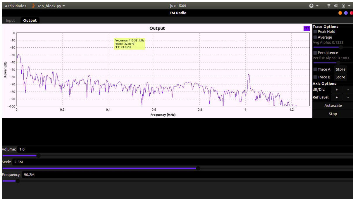
Figura N° 12: Señal de FM demodulada
