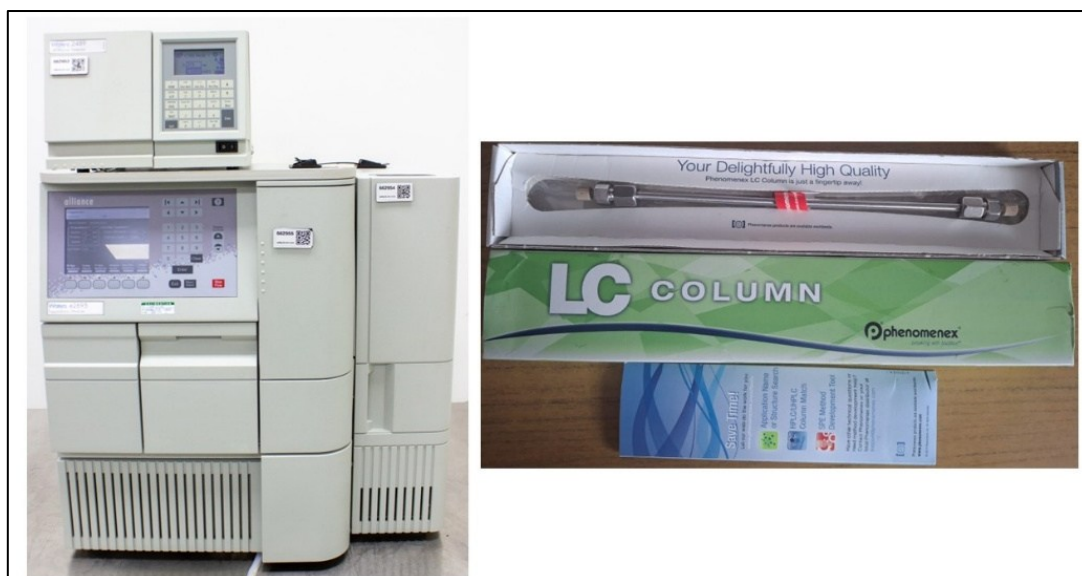
Figura 32. Cromatógrafo Waters Alliance e2695 Separation Module (izquierda); columna Phenomenex Luna 00G-4252-E0 (derecha).
