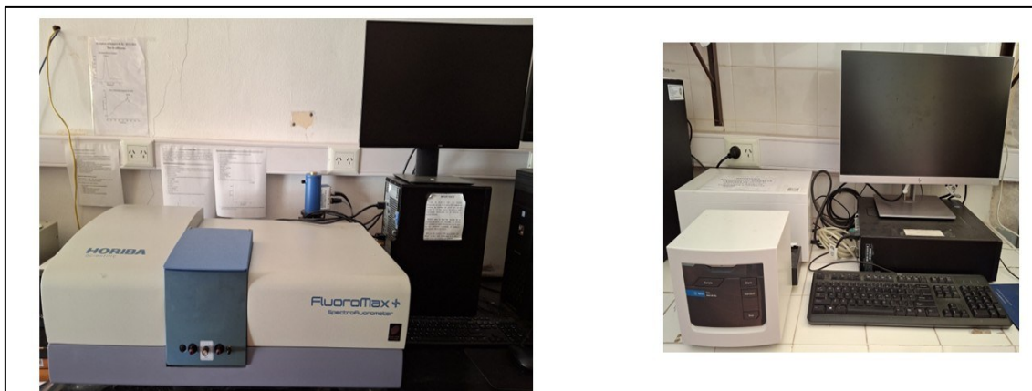
Figura 28. Equipos utilizados en los estudios de caracterización óptica: espectrofluorómetro (izquierda) y espectrofotómetro (derecha).
